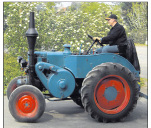
Lanz »Bulldog« Typ 7506 – Baujahr 1939, 24 PS, 20 Kilometer pro Stunde, Ein-Zylinder-Glühkopfmotor, 4767 Kubikzentimeter, 2,5 Tonnen Eigengewicht. »Kann bis zu 40 Tonnen ziehen«, lautete der Werbeslogan der Zeit. Der »Sparsame« war denn auch der meistverkaufte Traktor in Deutschland in den 1930er und 1940er Jahren. Die letzten rollten noch 1952 aus dem Werk in Mannheim, als sich bereits die Amerikaner von John Deere für das Werk zu interessieren begannen. Mit diesen und anderen Modellen hatte Lanz bis zu 50 Prozent Marktanteil. Kuriositäten: Die »Wegfahrsperrern«. Einen Bulldog zu steuern ist nicht einfach. Wer eine x-beliebige Lötlampe hat, scheitert trotzdem, wenn er nicht auch noch... das Lenkrad hat! Das – und ordentlich Muskelschmalz – braucht man nämlich noch, um der Kurbelwelle den entscheidenden Schwung zu geben, wenn der Zylinderkopf genug vorgeglüht hat.
